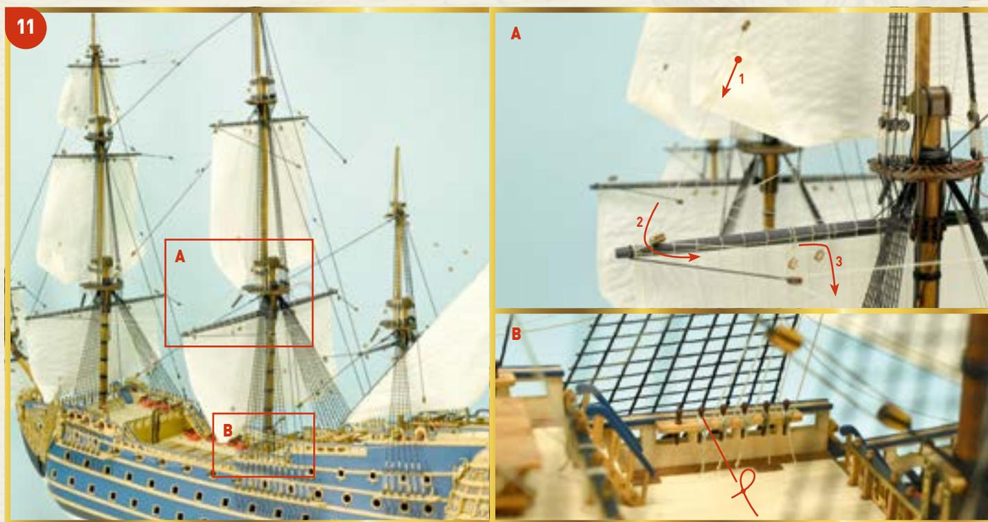
**11** Последними на парус S8 нужно установить шкоты. Закрепите нить в нижнем углу паруса и проденьте ее в оставшийся свободным блок на конце расположенного ниже рея (гюта-рея). Затем проведите нить через оставшийся свободным блок, расположенный рядом с центром гюта-рея, и, наконец, привяжите ее к кофель-нагелю, показанному на фотографии.
